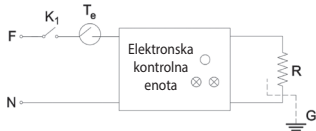
Slika 2. Električna shema digitalnega panelnega grelnika
