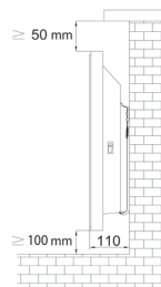
Slika 11: Odmiki grelnika po montaži
