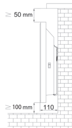
Slika 11: Odmiki grelnika po montaži
