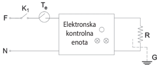
Slika 2. Električna shema digitalnega panelnega grelnika
